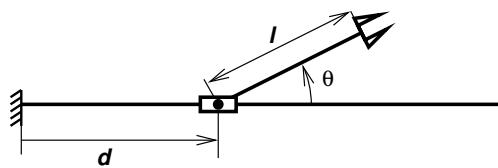
Kloubové souřadnice robotu  $d$ ,  $\theta$  a parametr robotu  $l$ .
