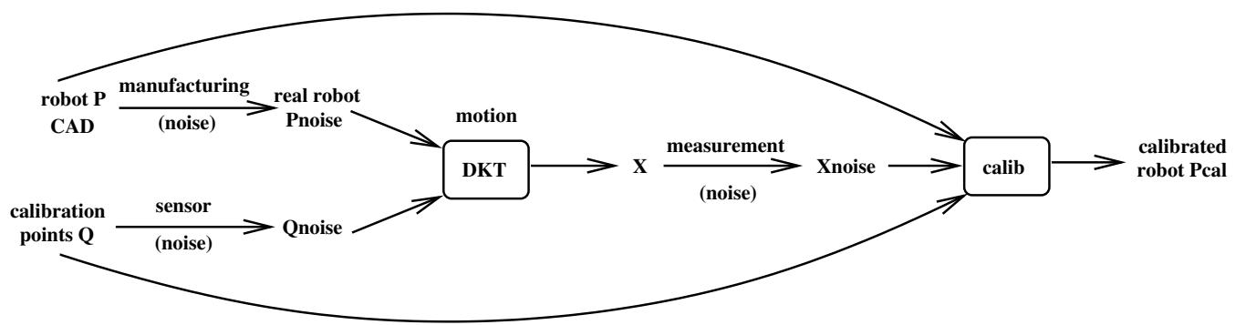
V domácí úloze máme robota a jeho CAD výkresy. Toho robota někdo nepřesně vyrobí, takže získáme robota s jinými parametry. Jestliže ho pošleme do polohy s kloubovými souřadnicemi  $Q$ , tak se vlivem nepřesnosti snímačů kloubových souřadnic dostane chapadlo do polohy  $X$ . Nezávislým měřidlem změříme polohu chapadla  $X_{noise}$ . Pro kalibraci robota použijeme výkresové parametry, odhadu (přání) kloubových souřadnic kalibračních bodů  $Q$ , naměřené
