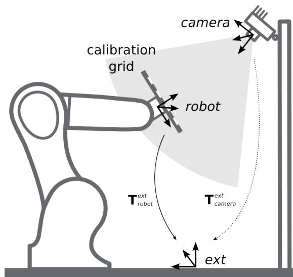
Často se dnes uplatňuje kamerový systém pro navigaci robotu na skutečnou polohu výrobku. V takovém případě musíme vzájemně zkalirovat souřadnicový systém, v kterém pracuje kamera, a souřadnicový systém robotu.
