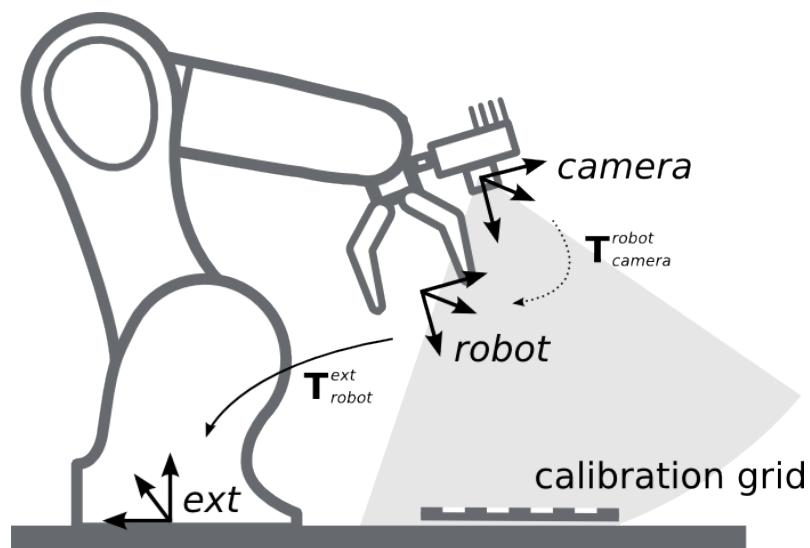
Jinou možností je umístit kameru přímo na chlapadlo robota. Kalibrační procedura je pak samozřejmě jiná a komplikovanější. Existují desítky metod, jak kalibrovat vzájemně robota a kamery a o jejich použití rozhoduje, co přesně o
