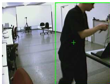
Obrázek 3.3: Atribut border – dotek hlavního objektu tří stran snímku.
