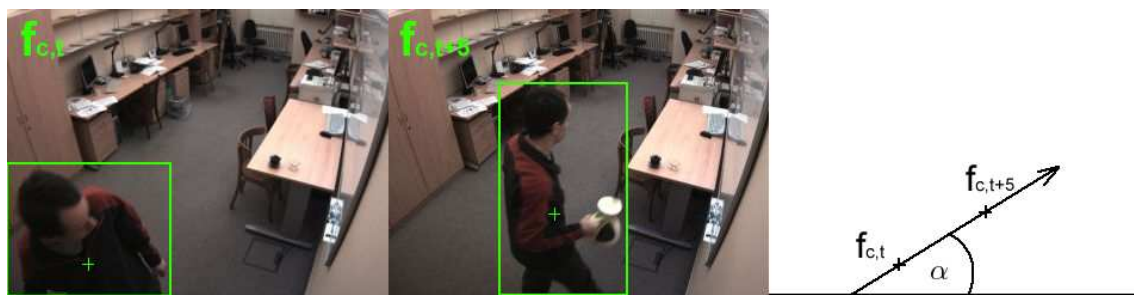
Obrázek 3.2: Atribut angle – směr pohybu hlavního objektu.
