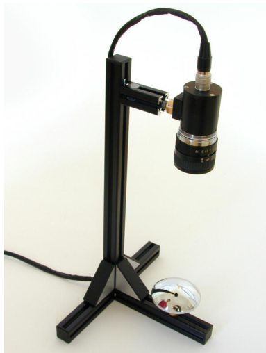
Obrázek 1: Panoramatická kata-dioptrická kamera s rovnoměrným rozlišením.
