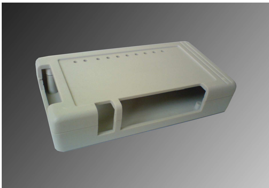
Obr. 4.6 Vyfrézovaná krabička KP24
