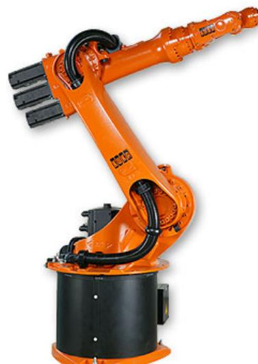
Angulární roboty mají dobrý poměr mezi objemem pravovní obálky a rozměry robotu.
