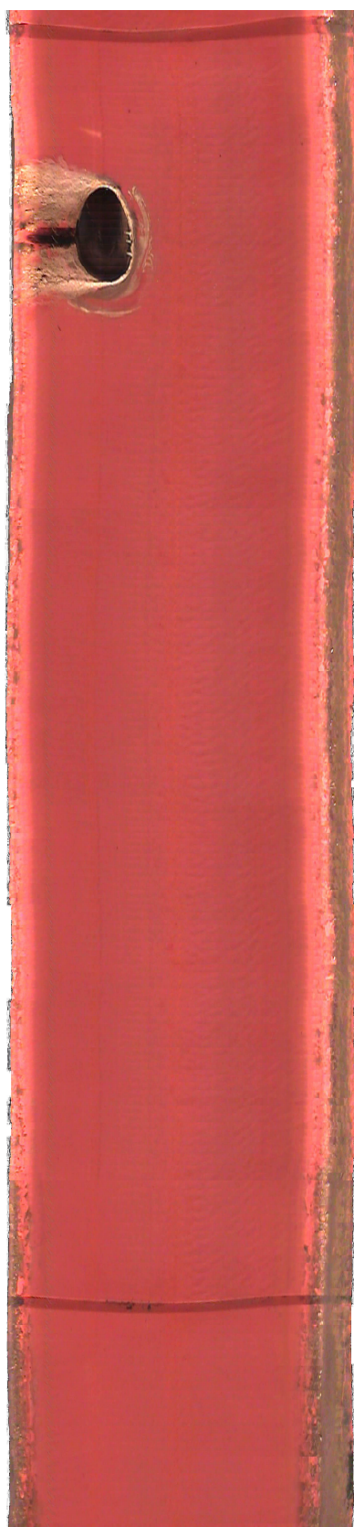
Obrázek 9.3: Výsledná mozaika - potrubí z PVC \varnothing 400 mm v délce cca 5.1 m.
